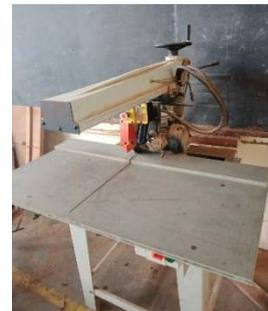
Gambar 16 . Jenis Mesin Berat, Mesin Radial Arm Saw
