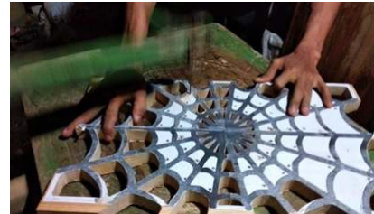
Gambar 23. Penyekrolan Komponen Sumber: Penulis, 2022
