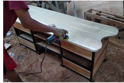
Gambar 22. Penghalusan Komponen Sumber: Penulis, 2022
