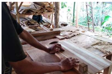
Gambar 20. Pemotongan Bahan Kayu Sumber: Penulis, 2022
