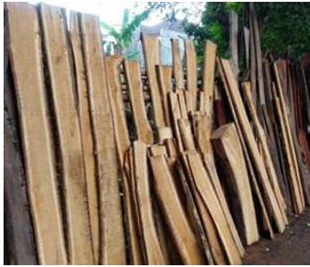
Gambar 18. Proses Pengeringan Kayu Sumber: Penulis, 2022
