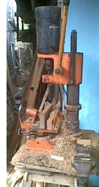
Gambar 20 Mesin Moutiser sangat membantu mempercepat membuat lubang purus Sumber : (Dokumen Penyusun, 2011)
