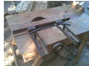
Gambar 21 Circle Saw/ gergaji yang berguna memotong kayu dengan ukuran yang sesuai dengan gambar kerja Sumber : (Dokumen Penyusun, 2011)
