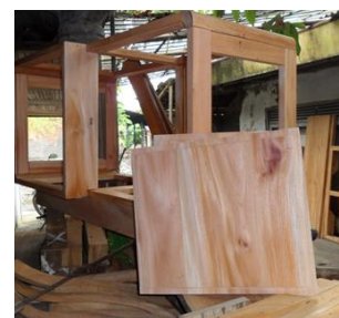
Gambar 23 Perakitan bagian lambung rak dengan dindingnya. Sumber : (Dokumen Penyusun, 2011)
