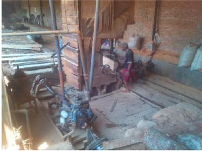
**Gambar 11** :Pembelahan Kayu dengan Mesin Bandsaw
