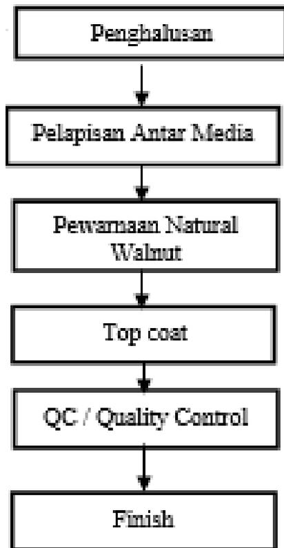
Skema 3. Detail Proses pembuatan produk
