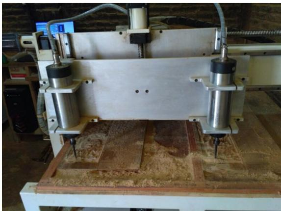
Gambar 8. Eksekusi *coding* menggunakan mesin CNC
