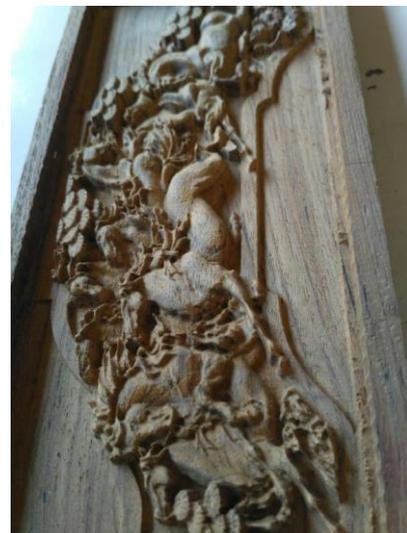
Gambar 9. Hasil ujicoba desain menggunakan mesin CNC Menggunakan motif tradisi
