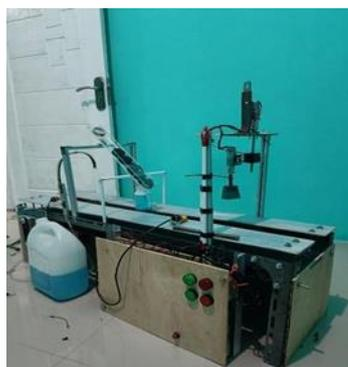
Gambar 7. Hasil Perakitan sistem filling capping berbasis Outseal PLC
