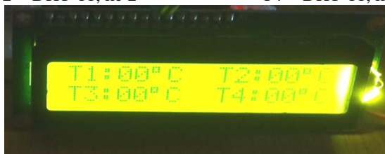
Gambar 3.1 Pengujian LCD display 16x2 ( Sumber : Dokumen Pribadi )
