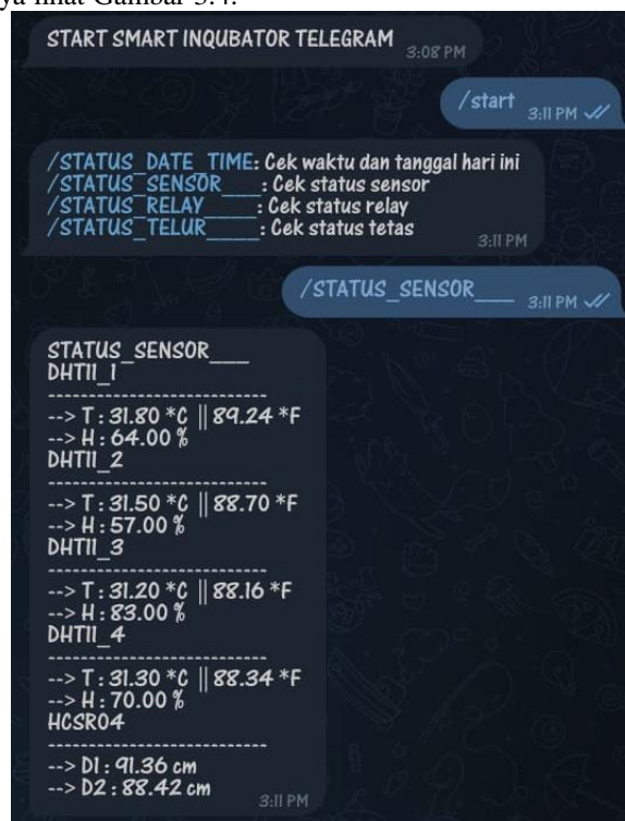
Gambar 3.4 Tampilan Pembacaan Suhu Pada Telegram ( Sumber : Dokumen Pribadi )
