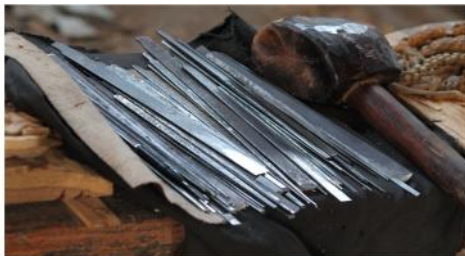
Gambar01. Pahat kreasi Hartono, diantaranya terbuat dari bahan ruji-ruji becak, seperti pada pahat pengot, coret, pengukud dan penilap kecil. Foto oleh Mumung Anggit Saputra, diambil tanggal Agustus 2015 di rumah Suhartono.
