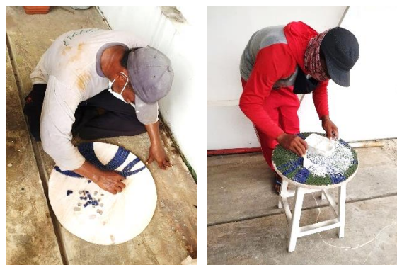
Gambar 11. Proses penyusunan mosaik dengan komposisi abstrak (kiri), dan proses menutup celah dengan semen putih (kanan).
