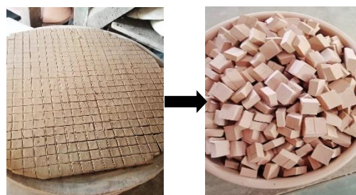
Gambar 3. Potongan tanah liat (kiri) dibakar biskuit hingga menjadi kepingan keramik (kanan).
