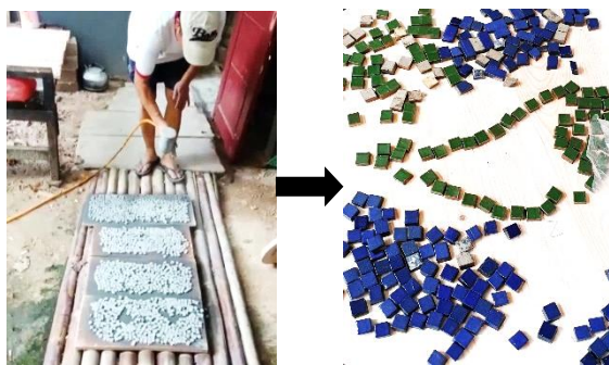
Gambar 4. Kepingan-kepingan keramik kemudian disemprot dengan glasir (kiri) dan dibakar kembali dengan permukaan yang berwarna (kanan)
